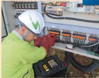
モジュールの出力特性と発電量を計測。セルのクラスタ落ちも検出できます。
