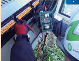
モジュールの電気的抵抗を測定し、断線やバイパスショートを確認します。
